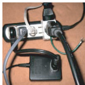
ADSLモデムの電源をタコ足配線している場合は、壁のコンセントから直接取るように変更。これで電源ノイズの影響を防げることも。
