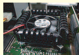
パソコンの内部には冷却する為のファンがいくつか設置してあります。
